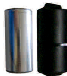
Пленочная безэлектролитная конденсаторная секция с термоусадочной трубкой-корпусом (предохранительных устройств нет)
