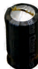
Электролитический конденсатор (в верхней части виден разрушенный предохранительный клапан)
