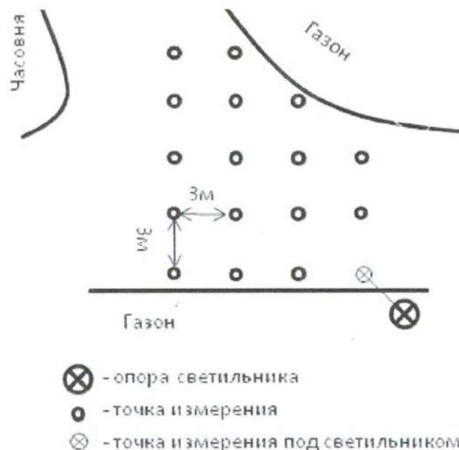
Рисунок А. Схема расположения контрольных точек проведения измерений горизонтальной освещенности.
