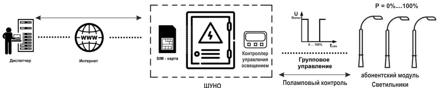
АСУНО PLC-light позволяет удаленно менять мощность/световой поток ОП в группе, измерять мощность каждого ОП и определять на какой опоре и с каким номером вышел из строя ОП (осветительный прибор).
