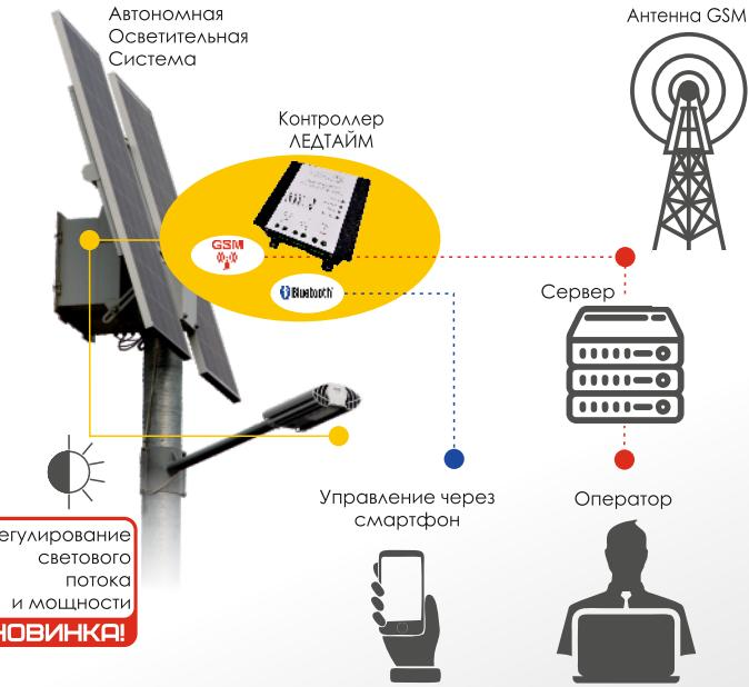
**Контроллер MPPT-ЛЕДТАЙМ с функцией диспетчеризации
