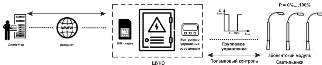
Схема удаленного управления освещением по технологии PLC-light
